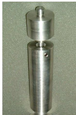
**foto 9** – Il supporto dell'antenna attrezzato a vertice geodetico
